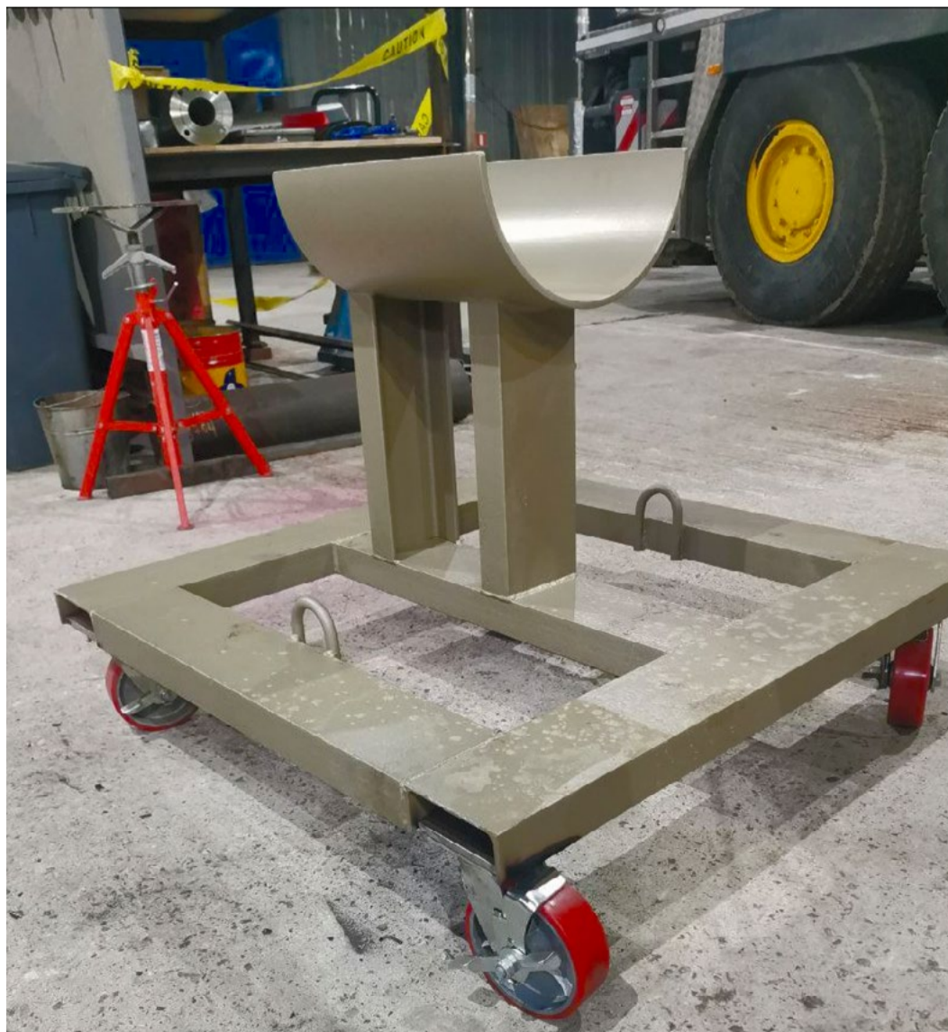
Ложемент помогает сохранить при транспортировке нежные механизмы – манжеты очистных скребков
