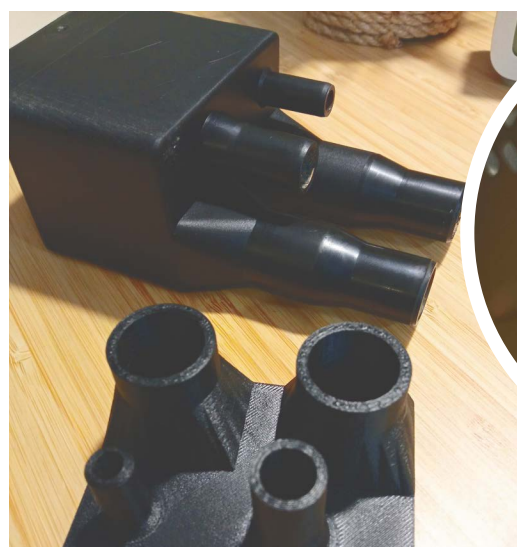
Новая деталь изготовлена на 3D-принтере
